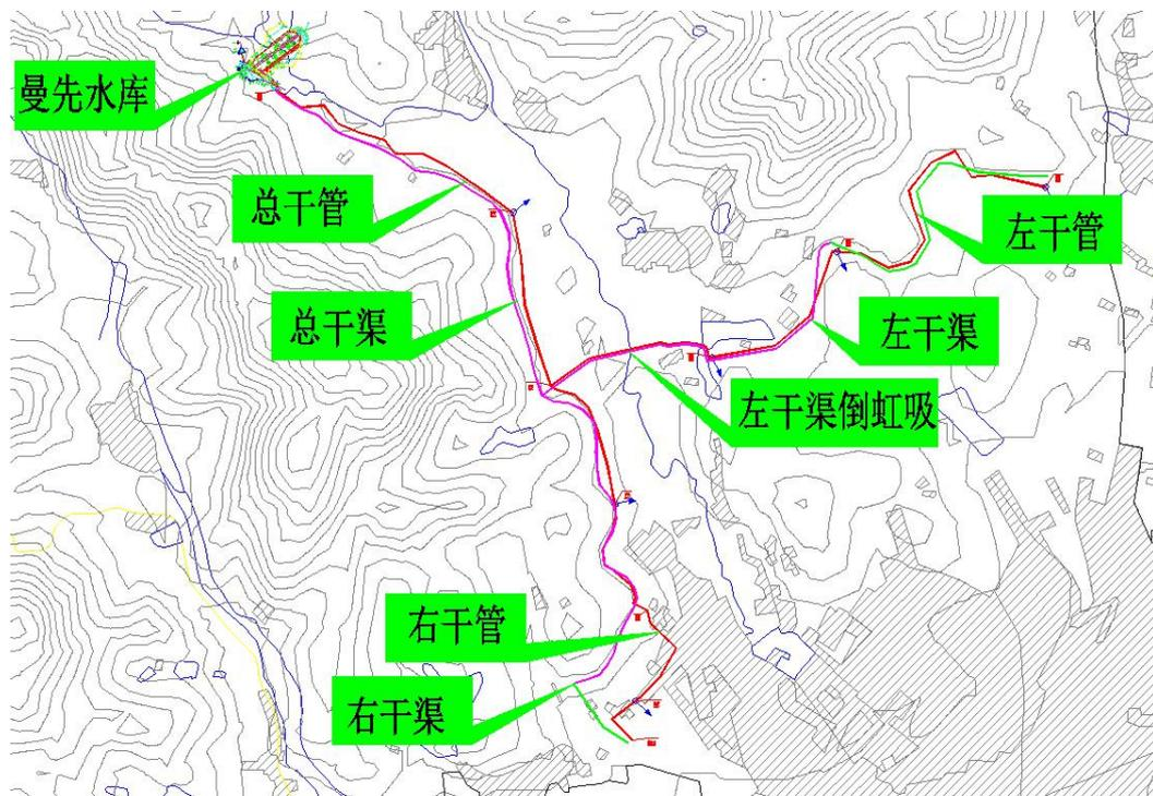
图 2-5 渠道、管道方案比较图
