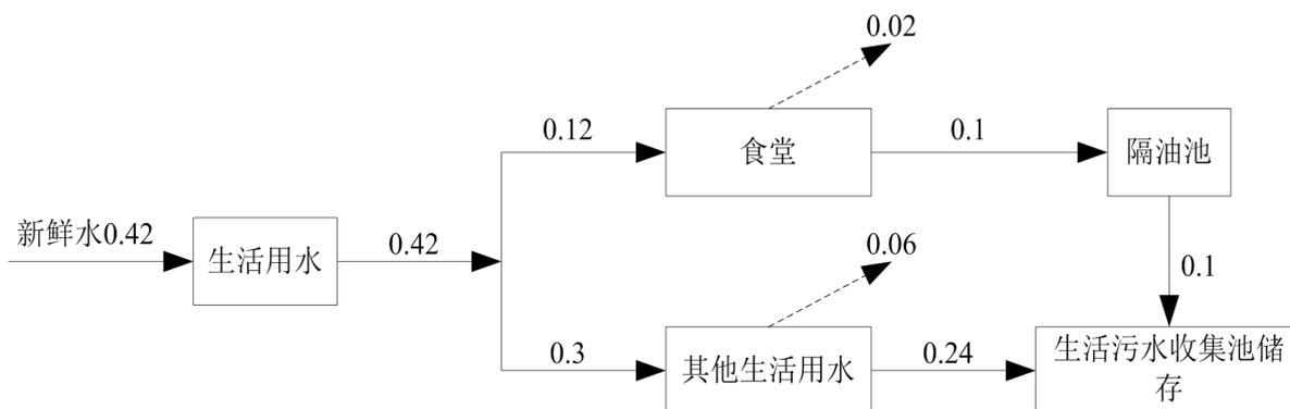
图 5-3 项目区雨天水平衡图  $\text{m}^3/\text{d}$
