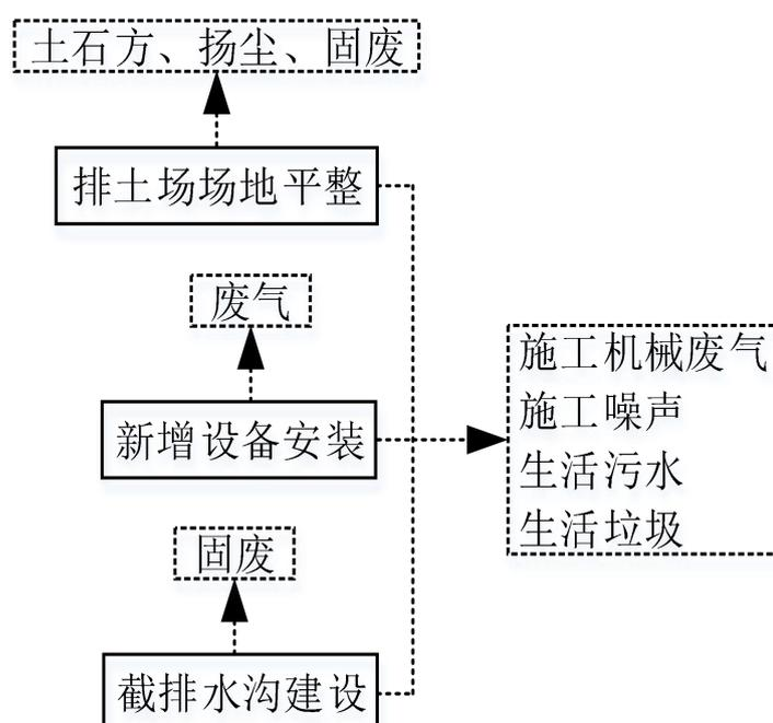
图 5-1 施工期工艺流程及产污节点图
