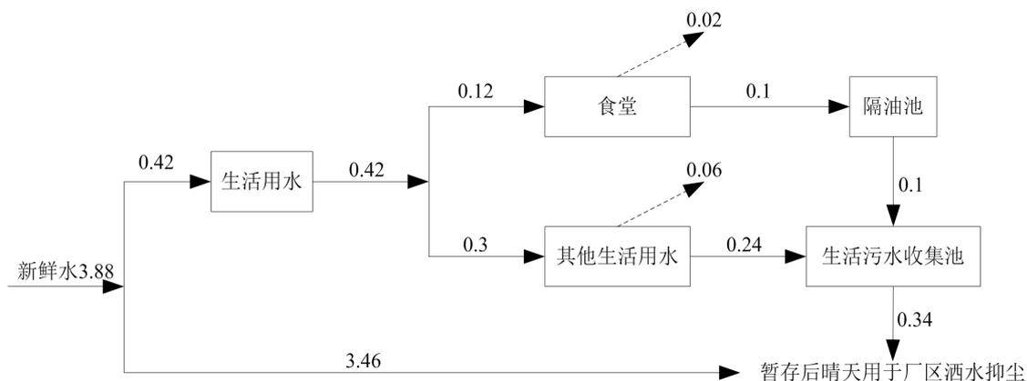
图 5-4 项目区非雨天水平衡图  $\text{m}^3/\text{d}$
