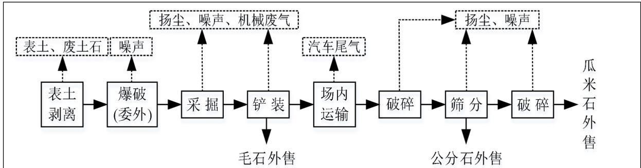
图5-2 运行期工艺流程及产污节点图
