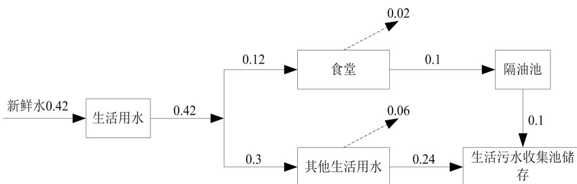
图 5-3 项目区雨天水平衡图 m<sup>3</sup>/d
