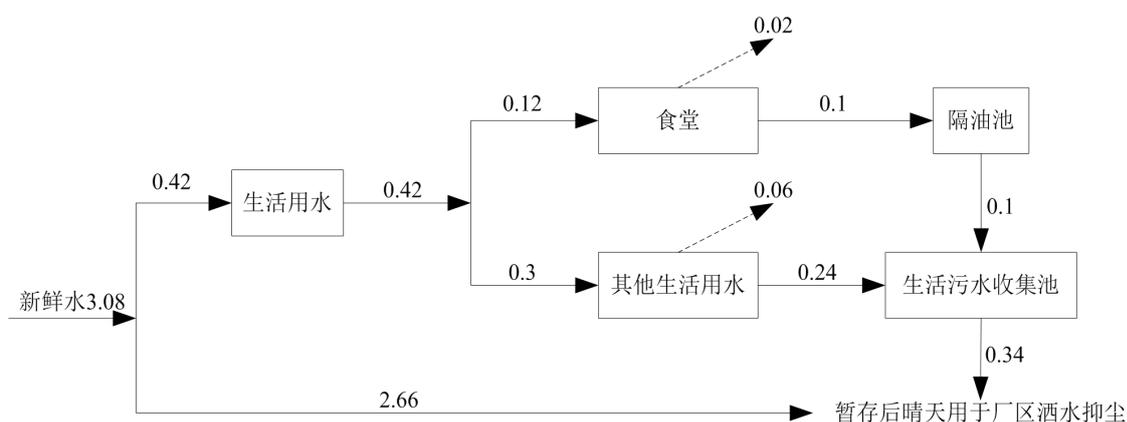
图 5-4 项目区非雨天水平衡图 m<sup>3</sup>/d
